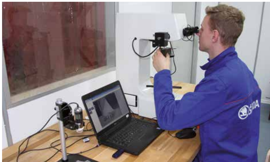
Svářečí inženýr Škoda Transportation Jakub Gärtner při měření tvrdosti svaru používaného při výrobě podvozků drážních vozidel
